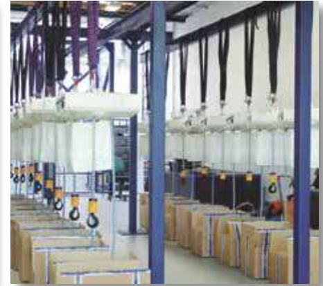
Inbetriebnahmestand Commissioning Station
